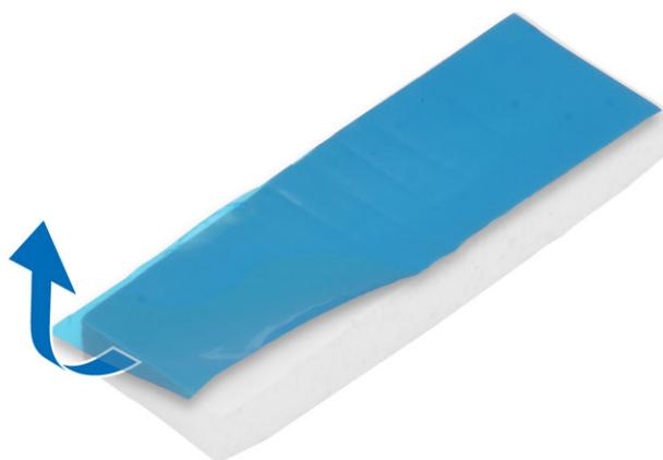
4. Coloque a borracha no computador [1] e retire a fita adesiva (rosa) da borracha [2].
